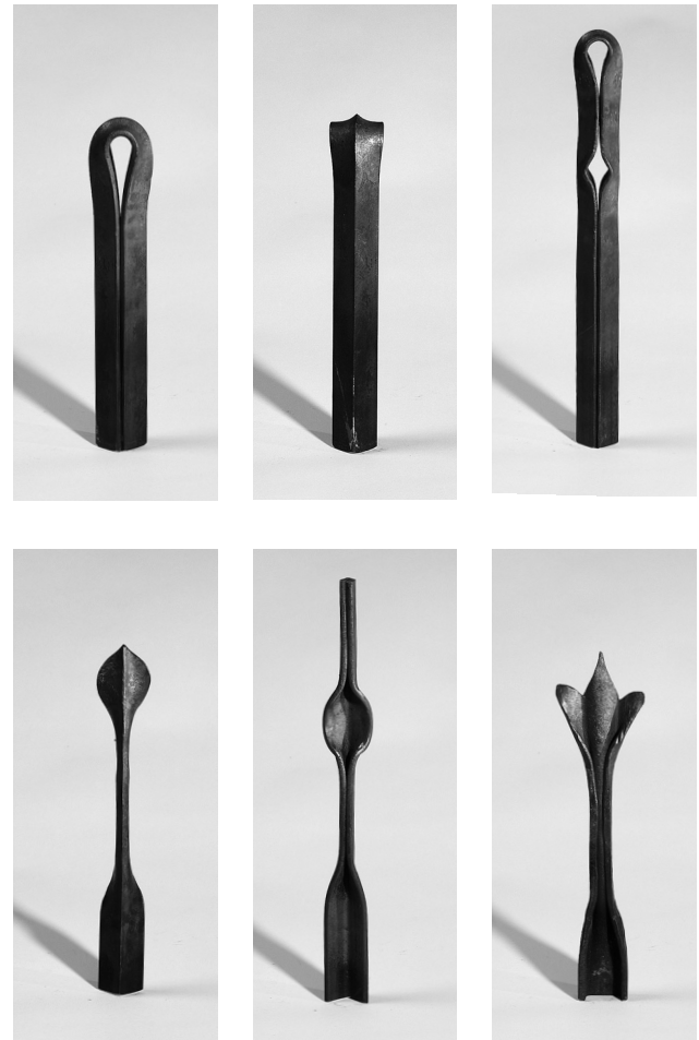
Arbeitsmuster aus Winkelstahl und U-Stahl für nebenstehenden Entwurf.
